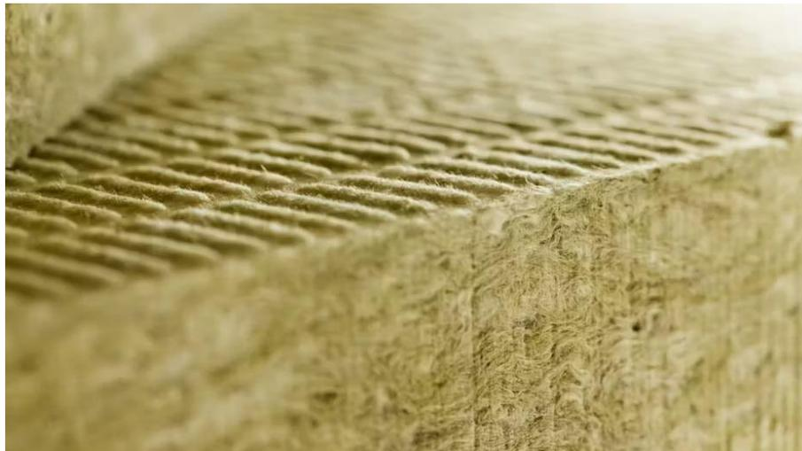
Dämmstoff ROCKWOOL Steinwolle, Bild: ROCKWOOL.
